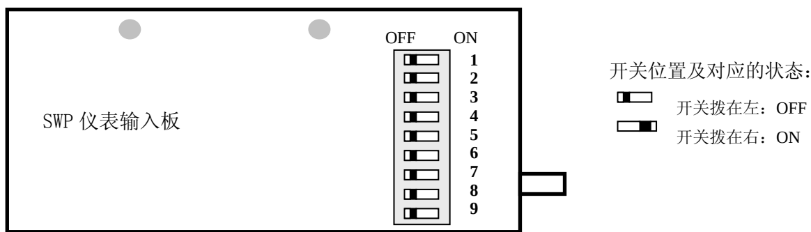
仪表输入板拨码开关位置组合与输入信号关系表：
